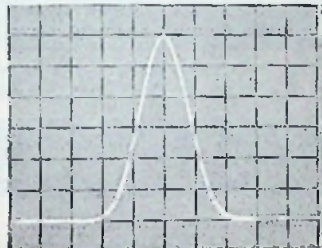
Waarschijnlijkheidskromme van pseudo-random gaussische ruis van de hp 3722a.
